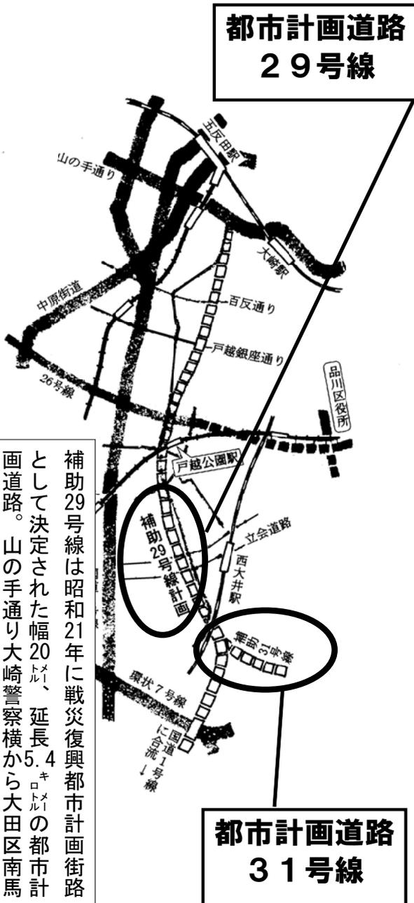
補助29号線は昭和21年に戦災復興都市計画街路として決定された幅20m、延長5.4kmの都市計画道路。山の手通り大崎警察横から大田区南馬込で国道1号線に合流します。
